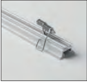
Molla per incasso controsoffitto e controcassa Foro incasso larghezza 19 mm - altezza 29 mm: Posizionare inizio-fine +1 ogni 50 cm. Spring for recessed ceiling. Recessed hole width 19 mm - height 29 mm. Place: beginning, end and 1 every 50 cm
