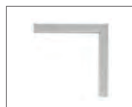
Lavorazione taglio ad angolo orizzontale 45° dei profili Horizontal 45° cutting of the profiles
