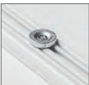
Supporto a calamita. Foro incasso larghezza 21 mm - Altezza 16 mm Posizionare inizio-fine +1 ogni 50 cm. Magnet support. Recessed hole width 21 mm - Height 16 mm Place: beginning, end and 1 every 50 cm
