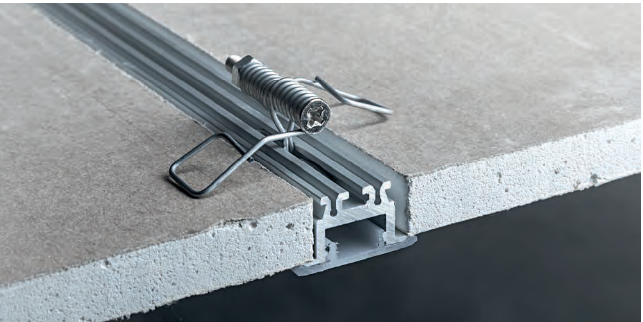
Molla a pressione Foro incasso larghezza 20 mm - Altezza 14 mm Posizionare inizio-fine +1 ogni 50 cm. Spring for recessed ceiling. Recessed hole width 20 mm - Height 14 mm. Place: beginning, end and 1 every 50 cm
